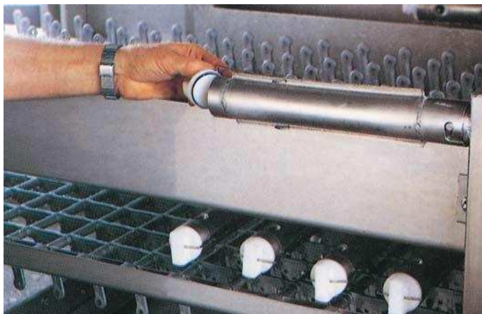
Cobertura nos terminais para inspeção
